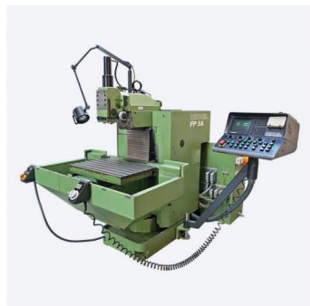
Deckel FP3A 2820 CNC-Fräsmaschine Aufnahme: SK40 X/Y/Z: 500/300/400 mm
