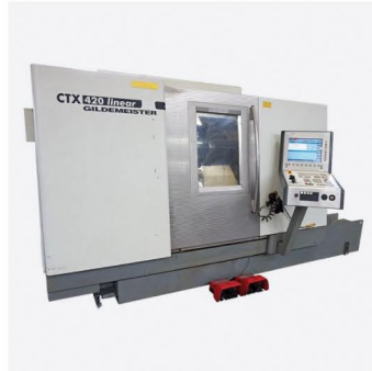
Gildemeister CTX 420 Linear CNC-Dreh- & Fräszentrum Drehlänge: 600 mm Umlauf- \phi : 680 mm Stangenladekapazität: 65 mm
