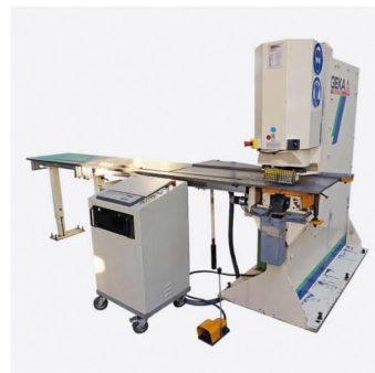
Geka PUMA 165S Stanz- & Schneidemaschine Kapazität: 165 to.
