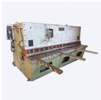
Darley GS 3016 Tafelschere Schnittlänge: 3000 mm Kapazität: 16 mm
