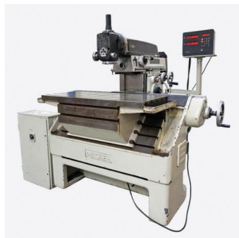
Deckel FP3L Universal-Fräsmaschine Aufnahme: SK40 X/Y/Z: 800/300/400 mm
