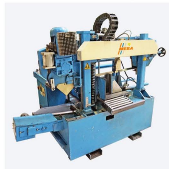
MEBA 335A Bandsägeautomat Kapazität rund: 335 mm
